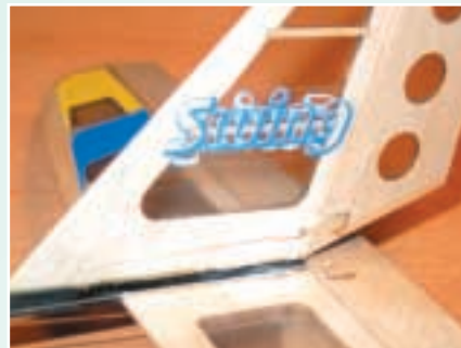
Die Anlenkung mit Nylonfäden auf Zug ist gewöhnungsbedürftig aber funktionell
