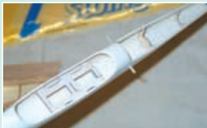
Im Rumpf sind bereits die Spanten fix und fertig eingeklebt
